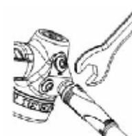
1. Проверьте регулировку IVS/RVS второй ступени, чтобы убедиться, что она установлена в "МИНУС" (-) положение, прежде чем устанавливать Ваш регулятор на вентиль.
