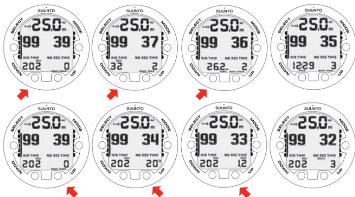
DOWN BUTTON TOGGLES BETWEEN O<sub>2</sub>, MAXIMUM DEPTH, TANK PRESSURE AND CURRENT TIME.
